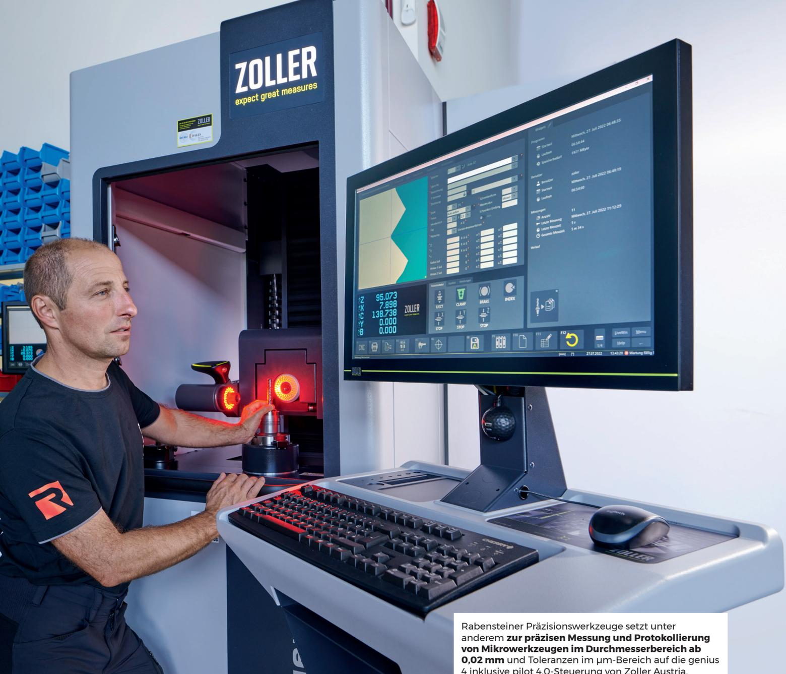
Rabensteiner Präzisionswerkzeuge setzt unter anderem **zur präzisen Messung und Protokollierung von Mikrowerkzeugen im Durchmesserbereich ab 0,02 mm** und Toleranzen im  $\mu\text{m}$ -Bereich auf die genius 4 inklusive pilot 4.0-Steuerung von Zoller Austria.
